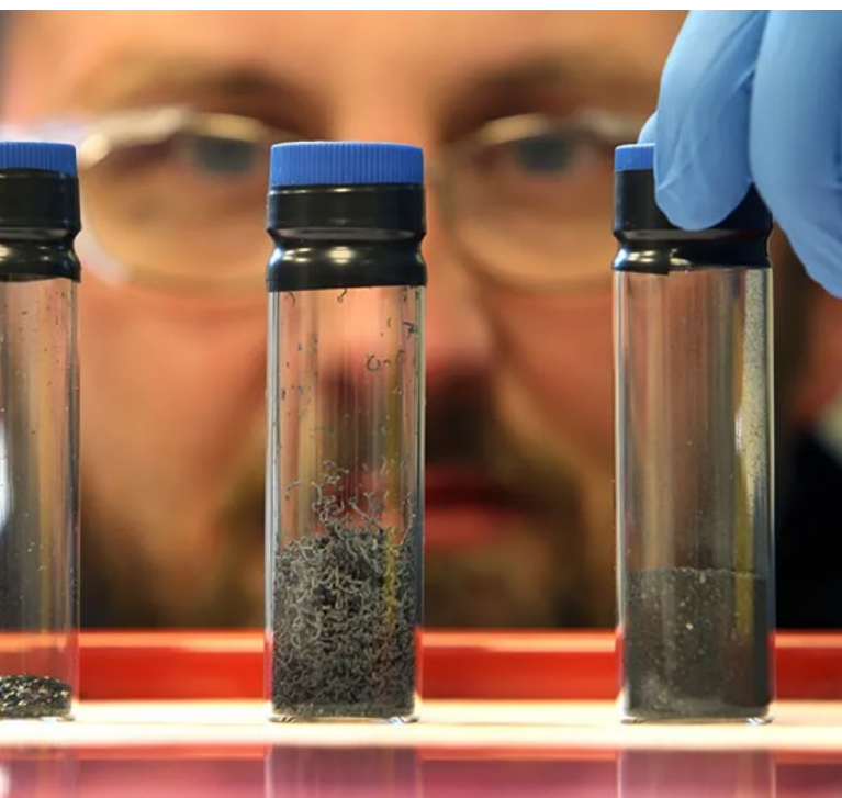
Графен — это однослойная форма обычного графита, однако получить одно вещество из другого не так просто, особенно в промышленных количествах. На фото запечатлена одна из технологий получения, в ходе которой чистый графит (слева) частично распадается на одноатомные слои, превращаясь в смесь графита и графена (справа). John Tlumacki / The Boston Globe / Getty Images
