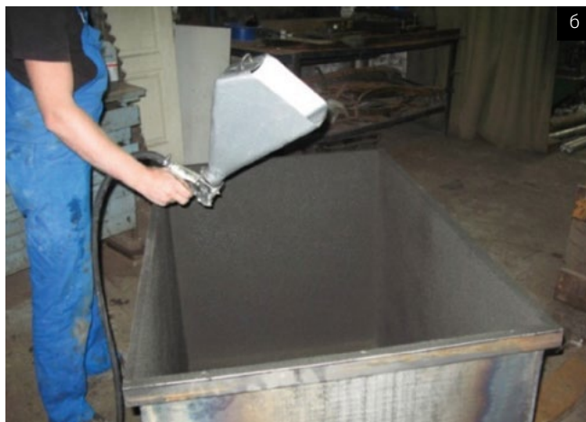
Рисунок 3. а — Шпатлевочный агрегат, б — Шпатлевочный пистолет
