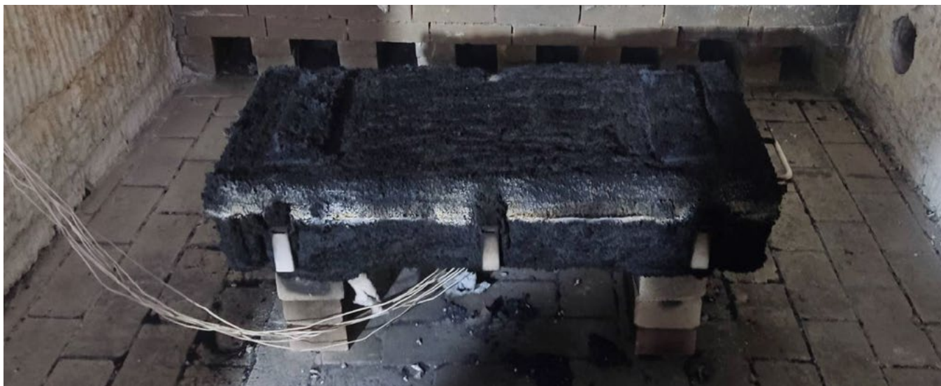
Рисунок 2. Образец изделия с огнезащитным терморасширяющимся гелькоутом после испытания на огнестойкость
