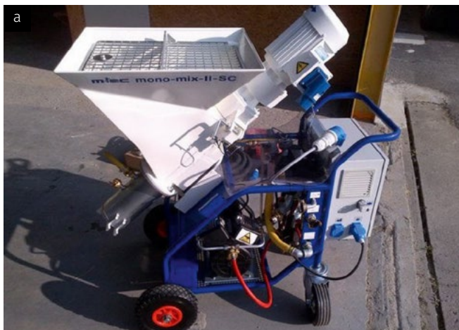
Рисунок 3. а — Шпатлевочный агрегат, б — Шпатлевочный пистолет
