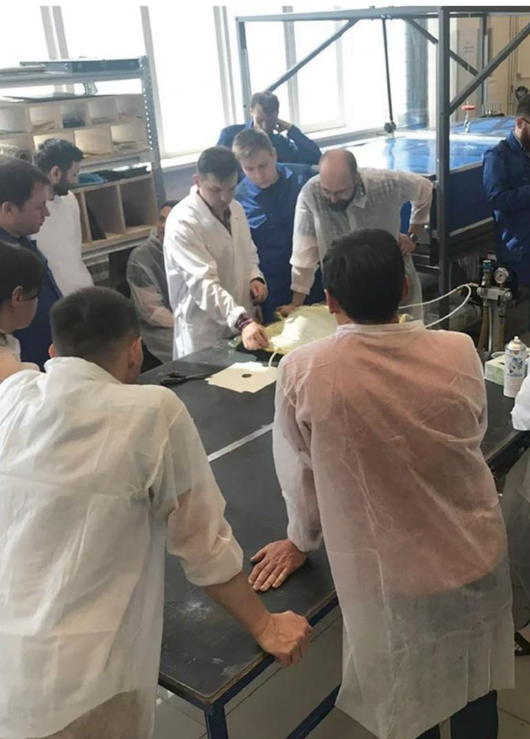
в ход пошли жгут КОНТУР-205, клей-спрей СР-FIX577, жертвенная ткань Р-ТЕКС-85ПА, распределительная сетка ПРО-СЕТ-200-2, трубки, переходники, и вакуумная пленка ВАКПЛЕН, давно зарекомендовавшие себя как надежные материалы для процесса вакуумной инфузии.
