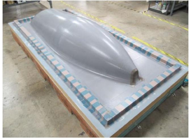
**Рисунок 2.** Мастер-модель с основанием, отремонтированной поверхностью и пленкой Tooltec.
