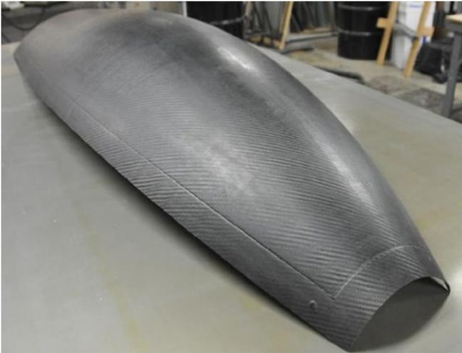
**Рисунок 15.** Отвержденная, полученная путем инфузии деталь из углеволокна, изготовленная с помощью оснастки при использовании NONA-технологии.
