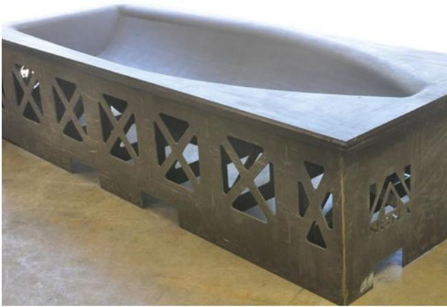
**Рисунок 1.** Оснастка со сводчатым участком, изготовленная из композитного материала без использования печи и автоклава.
