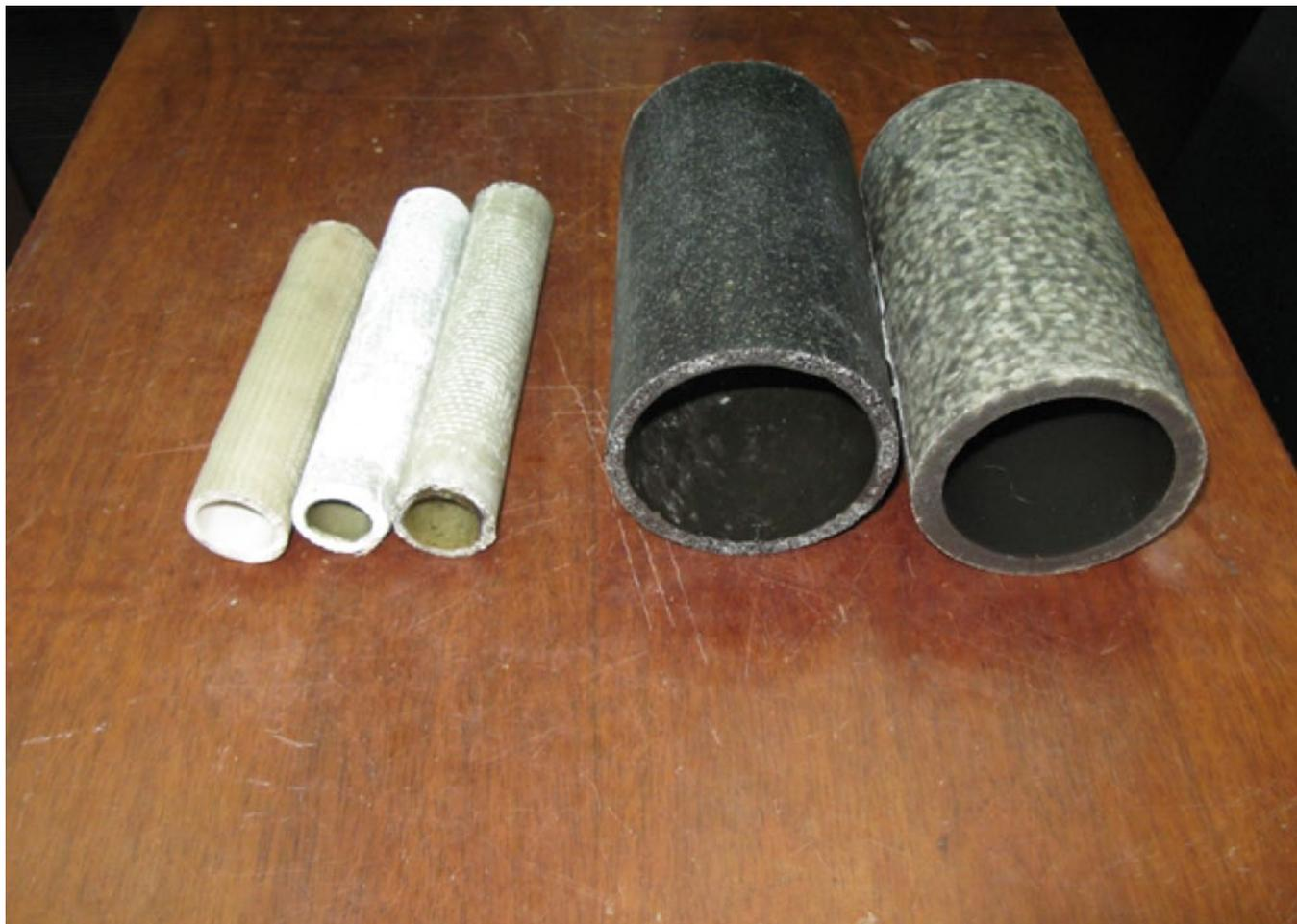
**Рисунок 2.** Трубные заготовки, полученные вращательным формованием.
