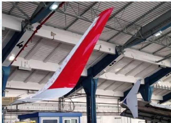
Airbus A320 с шарклетами: поставки новых машин с завода, уже оснащенных модернизированными законцовками, начались в феврале 2014 г. На сегодня в парке перевозчика насчитывается 12 таких A320.
