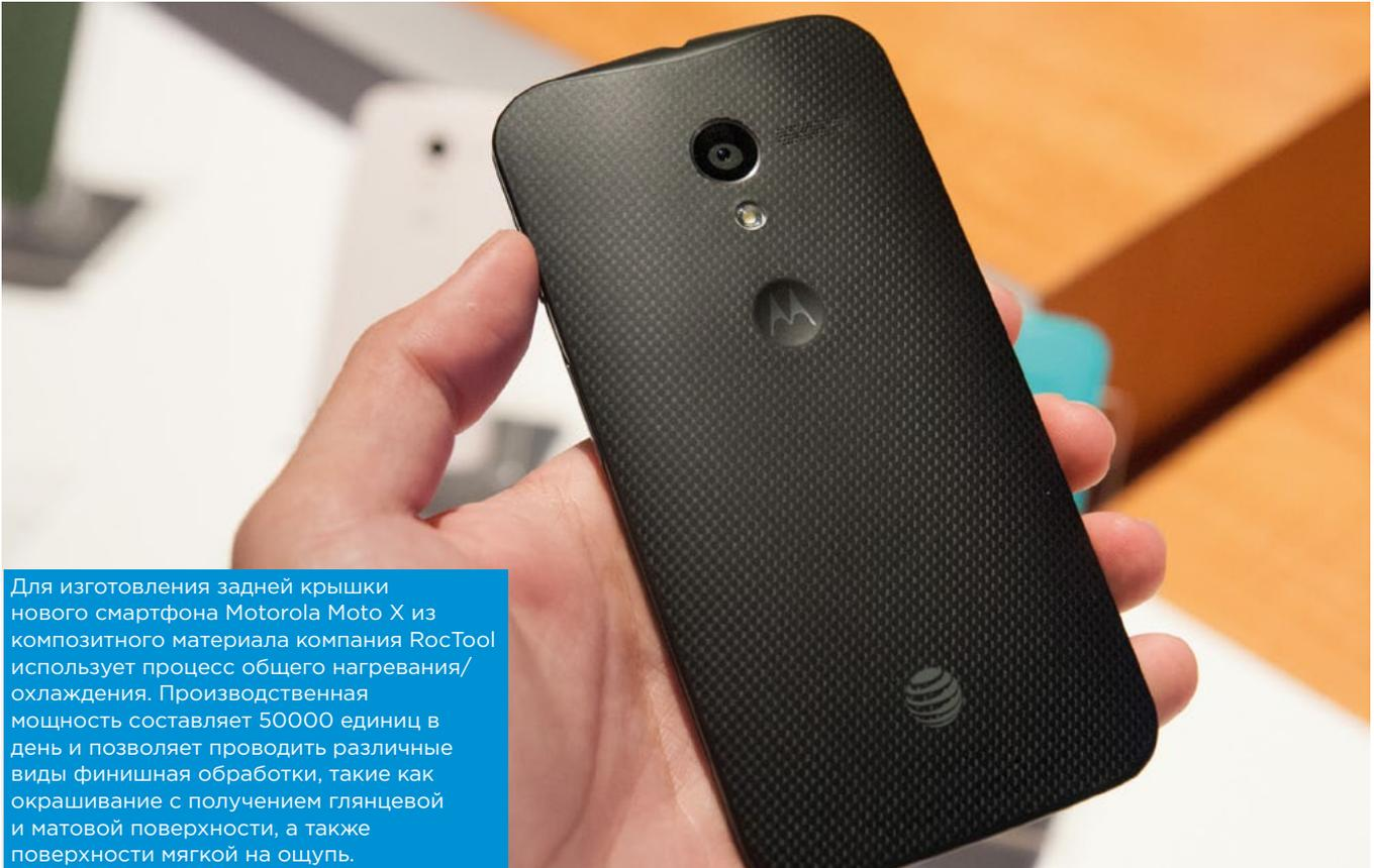
Для изготовления задней крышки нового смартфона Motorola Moto X из композитного материала компания RocTool использует процесс общего нагревания/охлаждения. Производственная мощность составляет 50000 единиц в день и позволяет проводить различные виды финишной обработки, такие как окрашивание с получением глянцевой и матовой поверхности, а также поверхности мягкой на ощупь.
