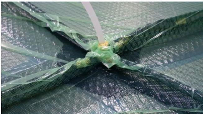
Поверх армирующей ткани укладывается жертвенная ткань **P6 MT85**. Её функции остаются теми же, что и при вакуумной формовке. При этом жертвенная ткань должна закрывать всю площадь изделия и также немного заходить на спиральную трубку.
