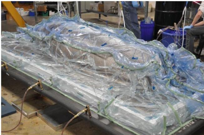
**Рисунок 3.** Получения первой части оснастки методом инфузии. Испытание 1.
