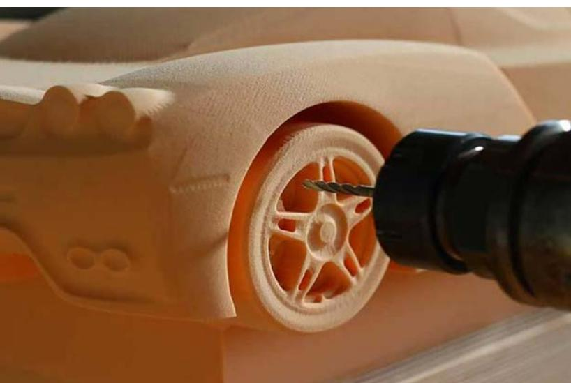
Ценится во всех областях моделирования, художественного оформления и резных работ, дизайна и быстрого прототипирования. Эта линейка пенопластов имеет некоторые несравнимые особенности, в том числе его великолепная обрабатываемость, точность очертаний, устойчивость к механическим нагрузкам, а также наличие разных плотностей (от 80 до 490 кг/м<sup>3</sup>).
