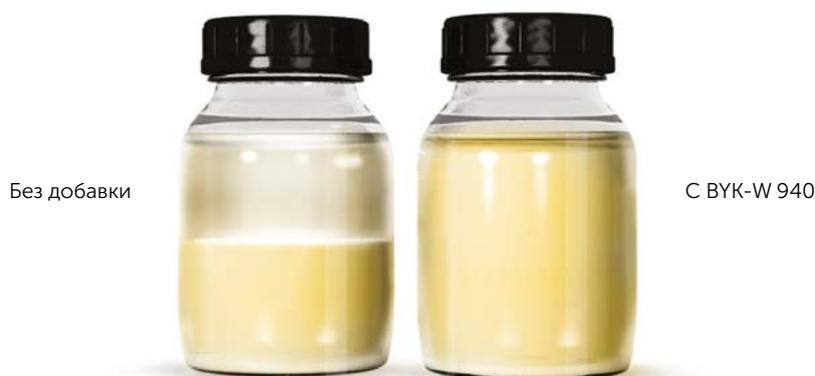
Рисунок 8. Противодействие оседанию, улучшенная стабильность при хранении.
