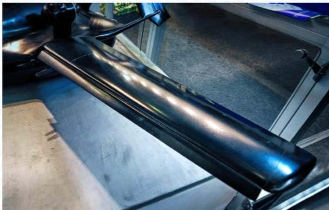
Исследования были нацелены на определение характеристик эффективности системы в нормированных условиях обледенения. Эксперимент проходил при температурах потока от 0 до минус 20°C в условиях воздействия переохлажденных водяных капель, аналогичных существующим в облаках. В ходе работ специалисты ЦАГИ выявили характерные особенности образования и удаления льда системой.
