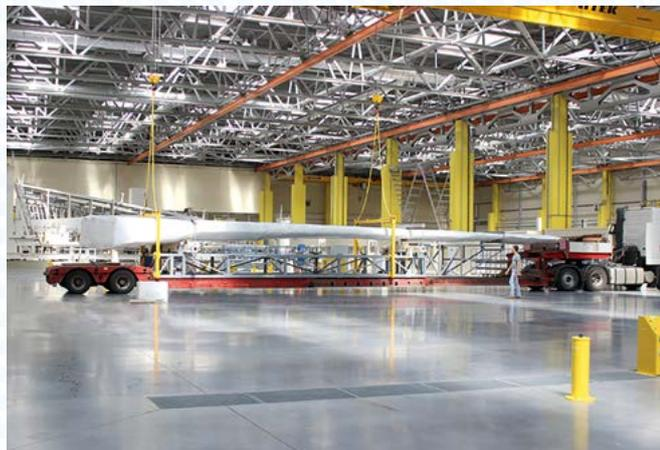
нели центроплана с методом вакуумной инфузии и автоматизированной выкладки сухого углеродного наполнителя. По информации АО «АэроКомпозит-Ульяновск», на предприятии освоена и реализуется технология сборки композитных и металлокомпозитных конструкций, ранее не применявшаяся в России.
