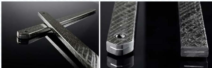
Исследователи из отделения гибридных материалов концерна Daimler и специалисты австрийской компании Secartechnologie GmbH разработали технологию непрерывного формования несущих деталей из углеволокна и металлической ленты. Такие усиливающие планки уже используются на некоторых автомобильных моделях, разработанных подразделением Mercedes-AMG — например, на кабриолетах C-класса и седанах S-класса.
