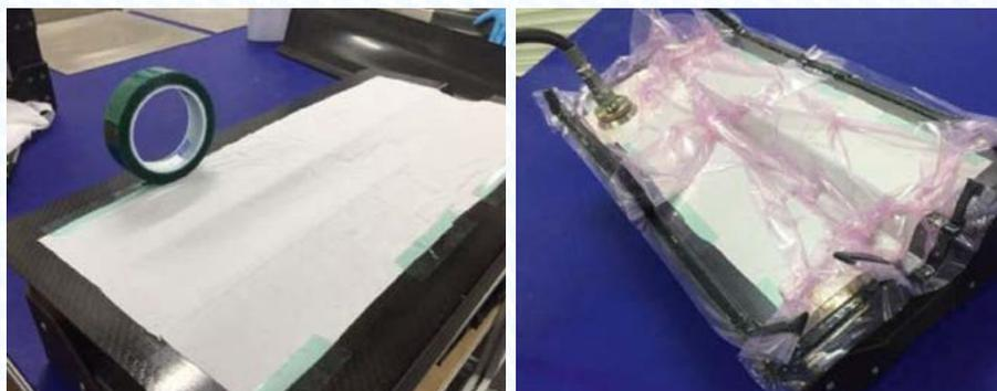
материалов. EsonoTare 1 и 2 могут использоваться для процессов при комнатной температуре и для температур до 177°C. Нарезанный на линии скотч Flashbreaker® 1 сокращает трудоемкость, наличие остатков и время. Новые шпатели для композитного ламинирования, используемые для выкладки препрегов и тканей Airsweep R2&R3 были спроектированы как эргономичные, соответствующие форме руки для более комфортного использования и для снижения усталости руки оператора даже при давлении в острые углы.
