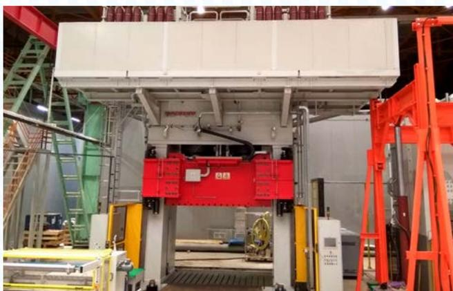
Оборудование для изготовления изделий из SMC-материалов подходит для серийного производства, так как обладает высокой производительностью.
